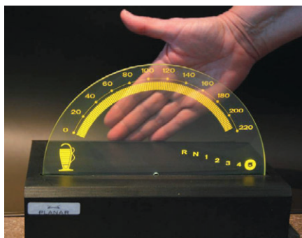
Рис. 11. Прозрачный ЭЛ-дисплей, используемый в модели для демонстрации дисплея с проекцией на лобовое стекло
