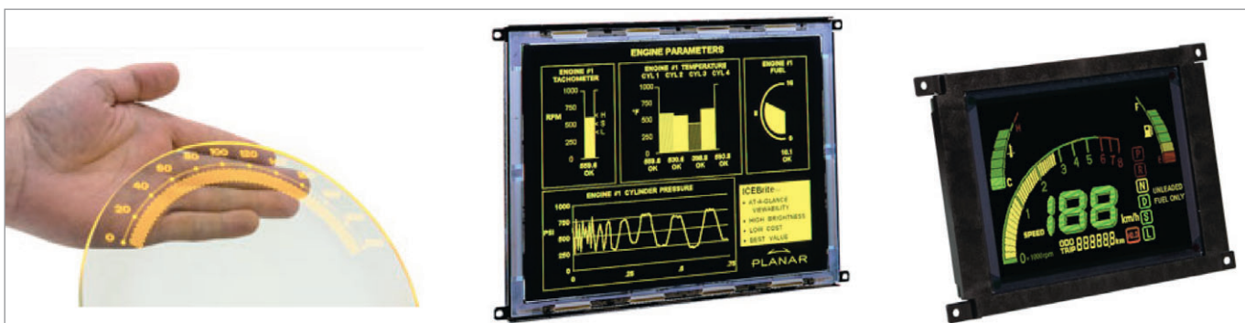
Рис. 1. Образцы прозрачных и многоцветных ЭЛ-дисплеев
