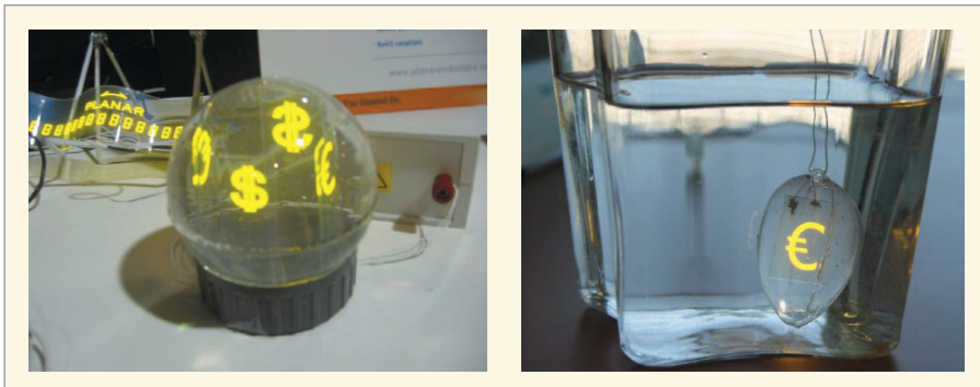
Рис. 14. Прототипы прозрачных ЭЛ-дисплеев, демонстрирующие их пространственную конструкцию
