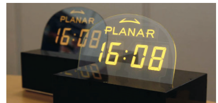
Рис. 2. Образцы прозрачного EL-дисплея. EL-дисплей, нанесенный на поверхность зеркала, находится на заднем плане
